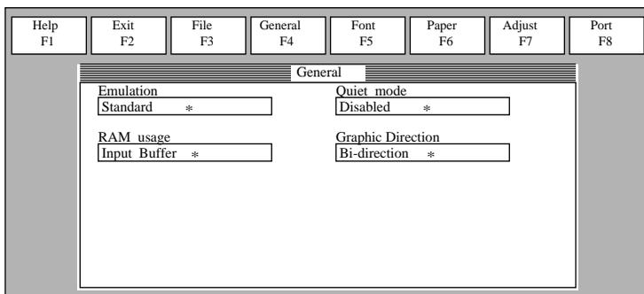
Когда вы запускаете программу STARSET, она считывает и показывает последнюю измененную конфигурацию, которая была передана ею на принтер.
